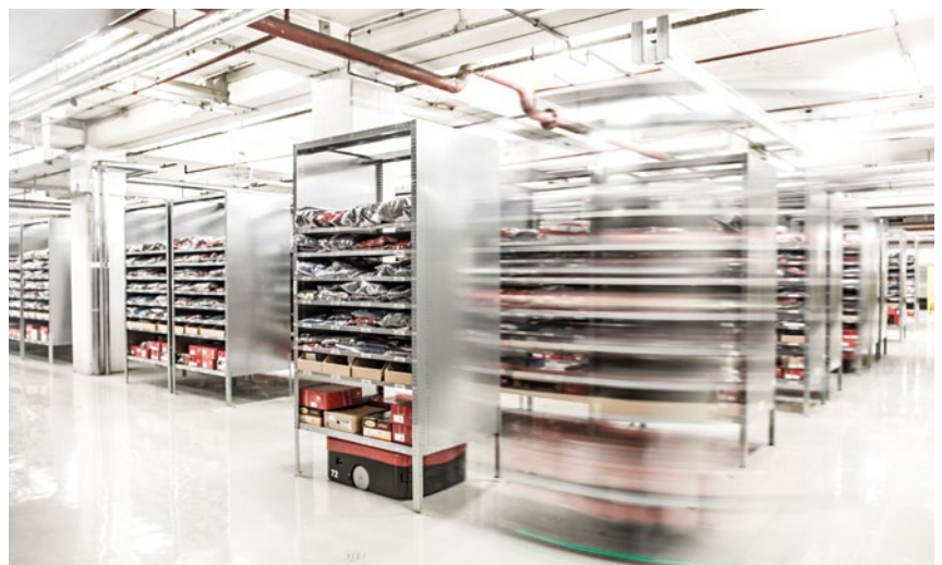
Bild 2: Beispiel für mobile Roboter, die ganze Regale zu den Kommissionierenden transportieren (Bildnachweis: tristan vankann/fotoetage).
