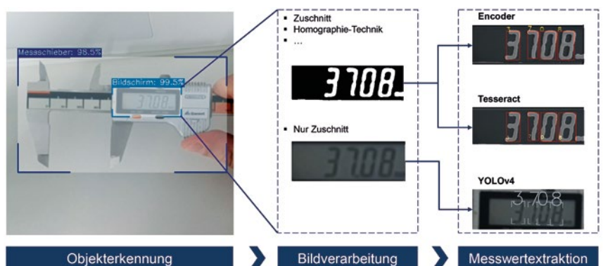
Bild 3: Visualisierung der Vorgehensweise für den Anwendungsfall digitaler Messschieber.
