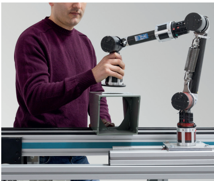
Bild 1: Aktiv nachgiebiger Roboter COMPI (Quelle: Annemarie Hirth, DFKI GmbH).
